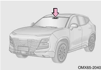
Микроволновое окошко расположено с внутренней стороне переднего лобового стекла и с правой стороны к задней части внутреннего зеркала заднего вида, где предназначено для беспроводной передачи радиочастотного сигнала и установки автомобильной электронной идентификации.
