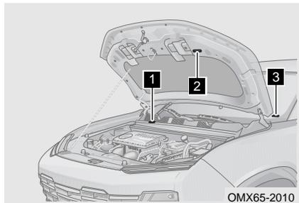
**1** Идентификационный номер автомобиля выгравирован в нижней части украшения капельного канала моторного отсека.
