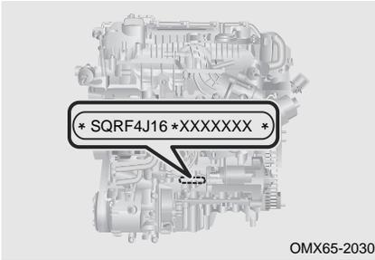
Номер двигателя указан на блоке цилиндров.
